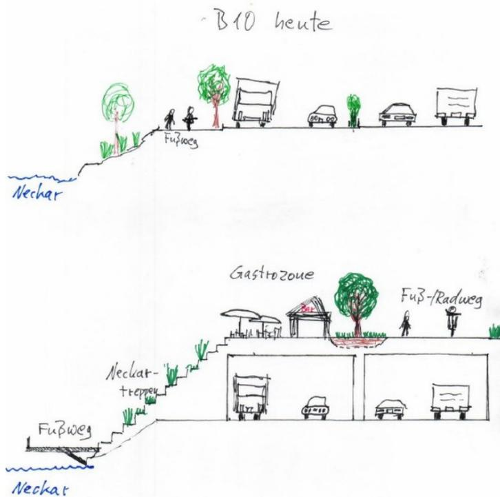
Das Erlebnisufer geht in Stufen zum Neckar hinab. Auf dem angedachten B10-Deckel befinden sich die Gastronomiemeile und ein Radschnellweg in Richtung Hedelfingen. Eine Stufe tiefer, direkt über dem Wasser, befindet sich der Spazierweg am Fluss. Hier könnte gar ein Flusslehrpfad entstehen, der den Menschen auf bunten Tafeln die Zusammenhänge und die Geschichte des
